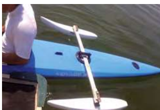
Flotteurs temporaires profilés et légers pour limiter les frottements.
